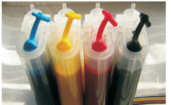
**Важно!** Обычно емкости располагаются на одном уровне с принтером. Если при печати случается частое пропадание нескольких дюз и прочистки не помогают, можно попробовать установить емкости на 2-3 см выше относительно принтера.
