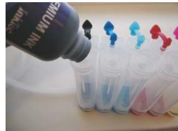
После заправки всех емкостей выньте воронки и плотно закройте отверстия цветной заглушкой. Воронки необходимо тщательно промыть проточной водой, чтобы в дальнейшем использовать для дозаправки СНПЧ. Затем в каждый из воздушных отсеков поместите воздушный фильтр, предотвращающий попадание пыли в процессе эксплуатации СНПЧ, как показано на рисунке:
